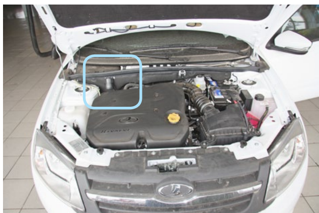
Фото 2.1. Возможное место установки сирены
