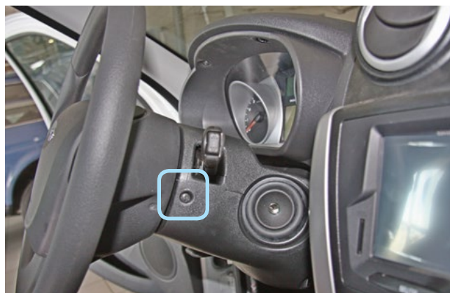
Фото 1.6. Саморез крепления нижней части кожуха рулевого вала справа
