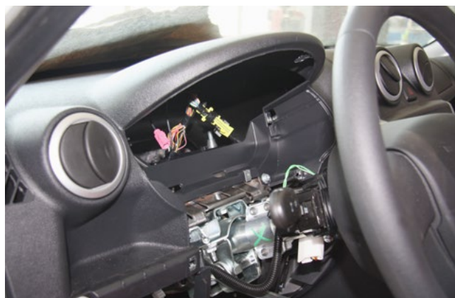
Фото 1.12. Панель приборов снята
