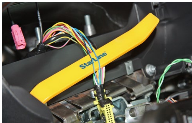
Фото 3.5. Управление световыми сигналами (синий и сине-чёрный)
