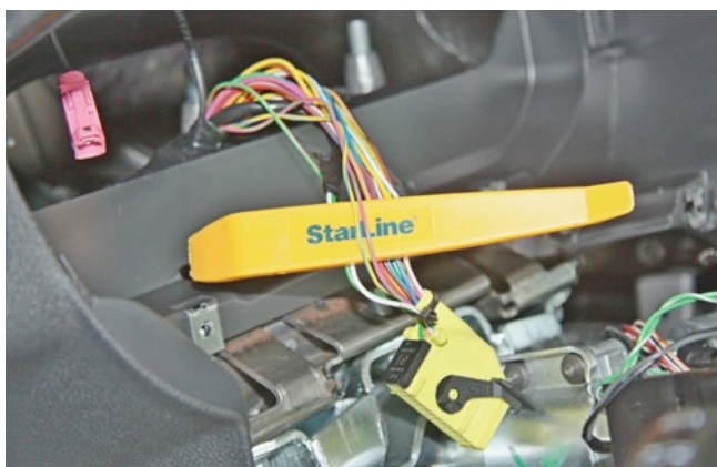
Фото 3.2. Шина CAN-A (розово-зелёный и жёлто-синий)
