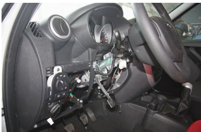
Фото 1.7. Кожух рулевого вала снят
