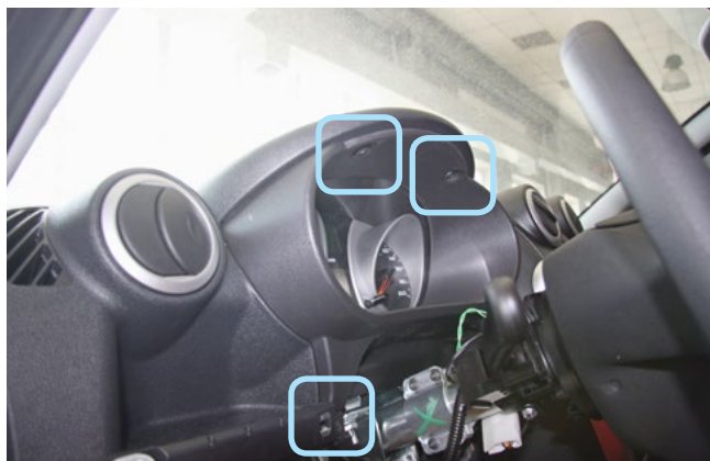
Фото 1.9. Саморезы крепления декоративной накладки панели приборов
