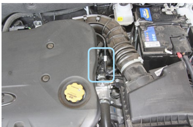
Фото 2.3. Место установки датчика температуры двигателя
