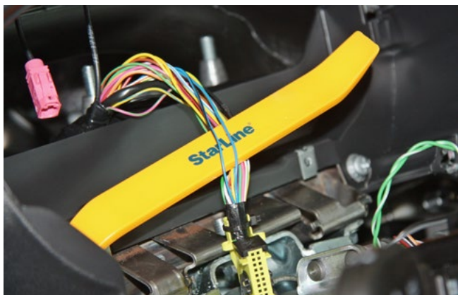
Фото 3.5. Управление световыми сигналами (синий и сине-чёрный)
