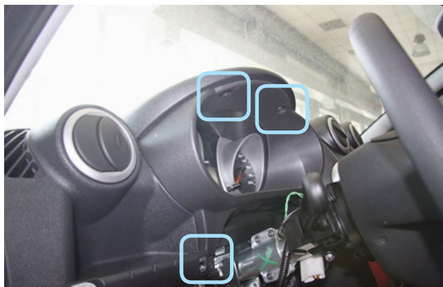
Фото 1.9. Саморезы крепления декоративной накладки панели приборов
