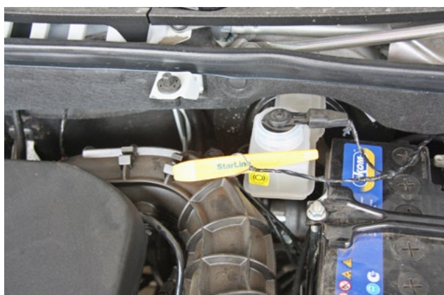
Фото 2.5. Концевик капота (бело-чёрный)
