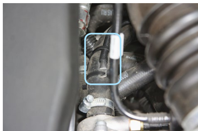
Фото 2.4. Крепление датчика температуры двигателя
