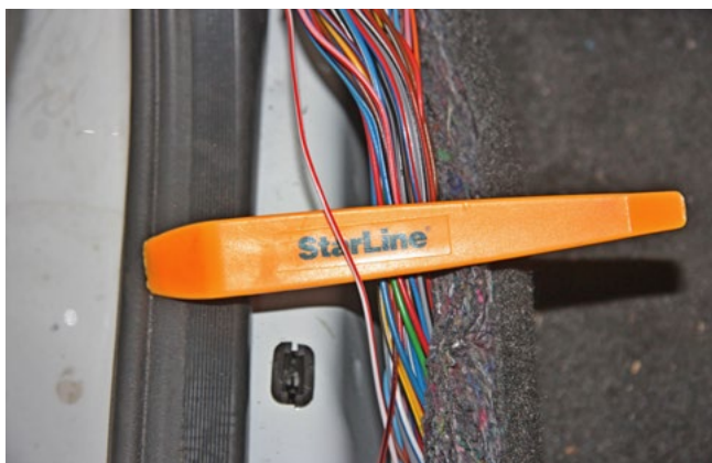
Фото 3.3. Концевик багажника (бело-красный)
