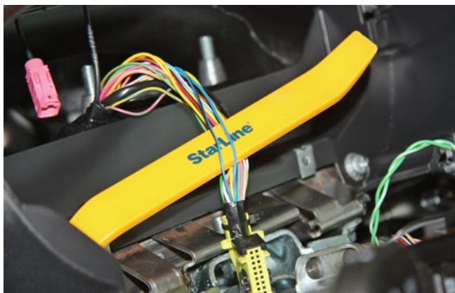
Фото 3.5. Управление световыми сигналами (синий и сине-чёрный)
