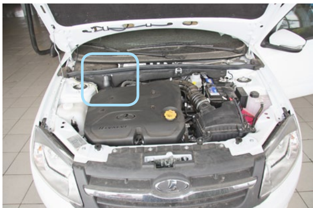
Фото 2.1. Возможное место установки сирены
