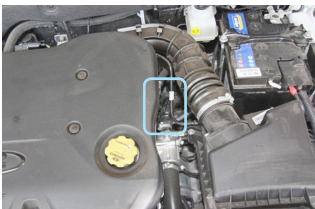
Фото 2.3. Место установки датчика температуры двигателя
