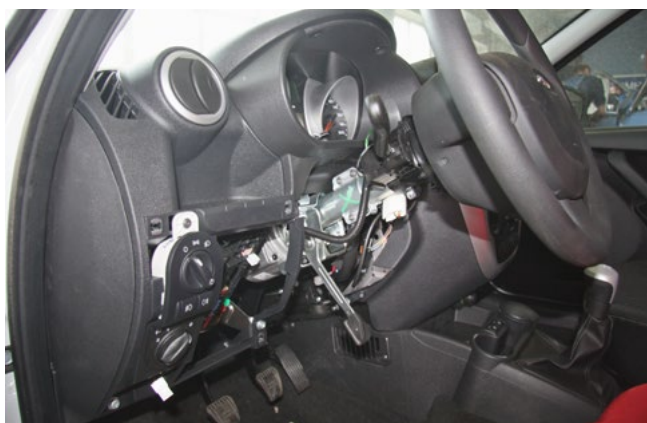
Фото 1.7. Кожух рулевого вала снят
