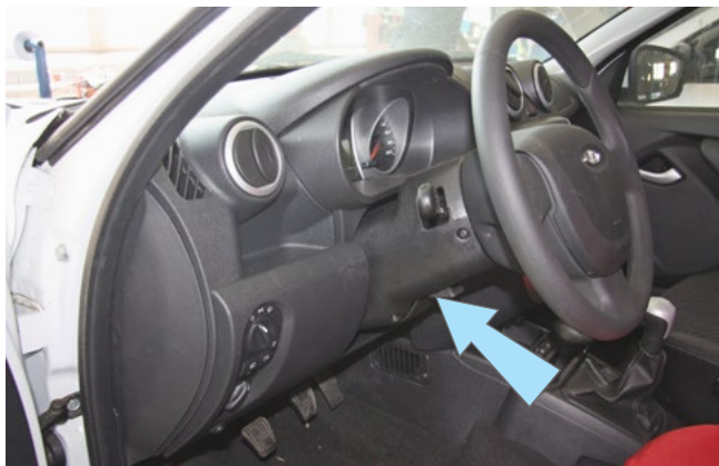
Фото 1.1. Кожух рулевого вала
