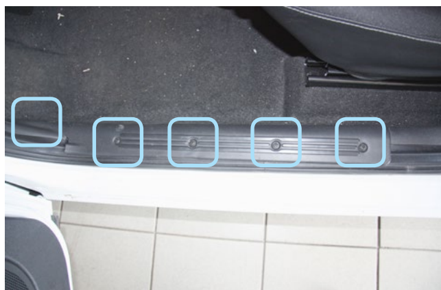
Фото 1.8. Саморезы крепления накладки порога двери водителя
