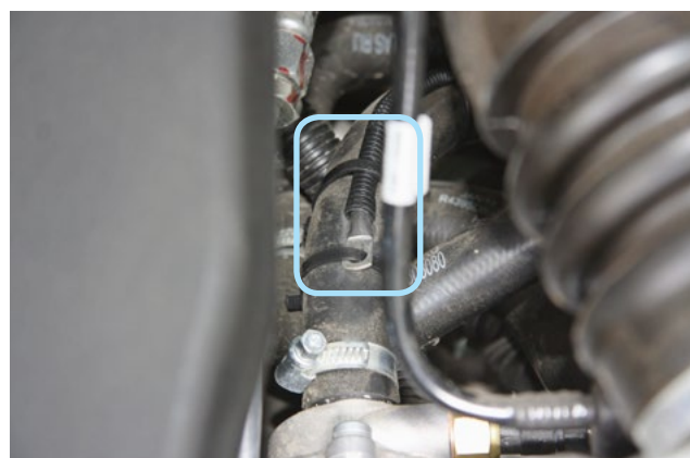
Фото 2.4. Крепление датчика температуры двигателя
