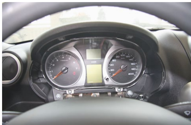
Фото 1.10. Декоративная накладка снята
