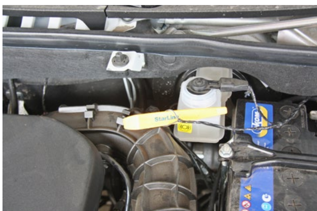
Фото 2.5. Концевик капота (бело-чёрный)
