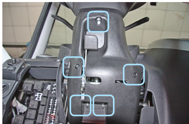
Фото 1.4. Саморезы и болты крепления кожуха рулевого вала снизу
