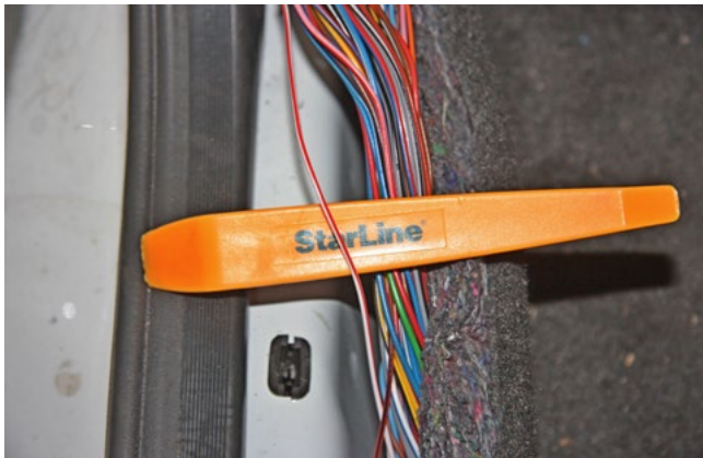
Фото 3.3. Концевик багажника (бело-красный)
