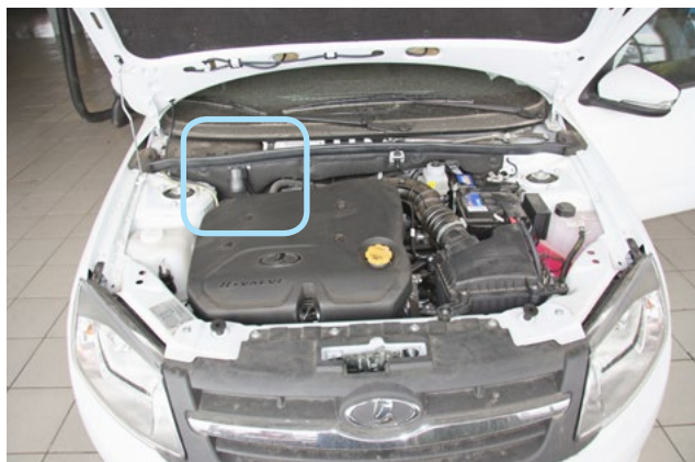
Фото 2.1. Возможное место установки сирены
