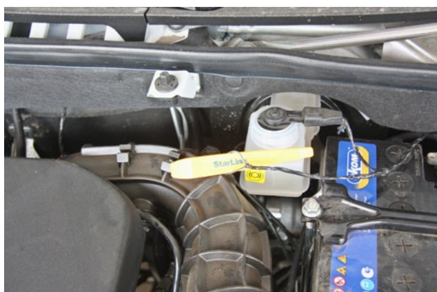
Фото 2.5. Концевик капота (бело-чёрный)
