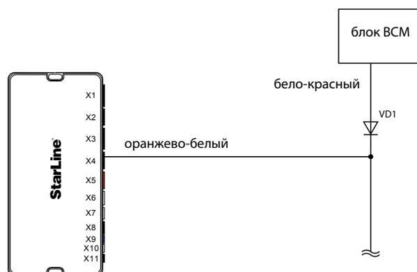
Схема 3. Подключение концевика багажника
