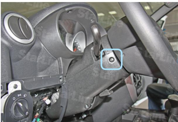
Фото 1.5. Саморез крепления нижней части кожуха рулевого вала слева
