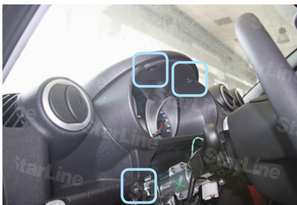
Фото 2.1. Саморезы крепления декоративной накладки панели приборов
