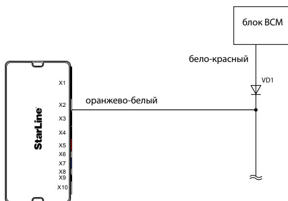
Схема 3. Подключение концевика багажника
