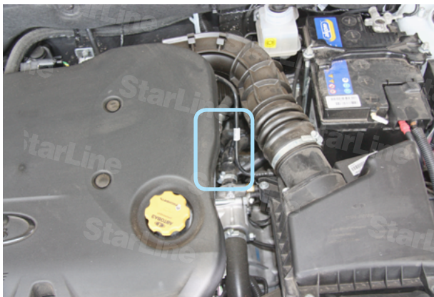
Фото 4.3. Место установки датчика температуры двигателя
