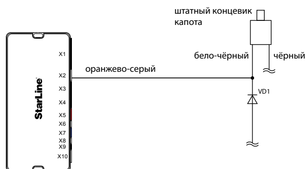
Схема 1. Подключение концевика капота
