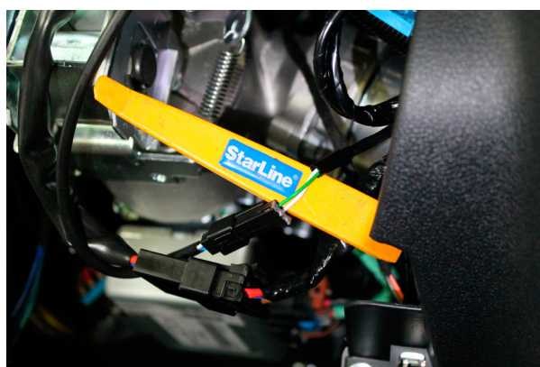
Фото 10. Провода рамки штатного иммобилайзера (белый и зеленый)
