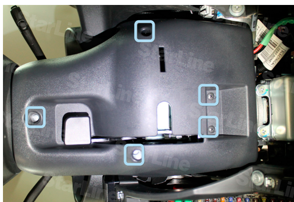
Фото 1.4. Саморезы крепления рулевого кожуха
