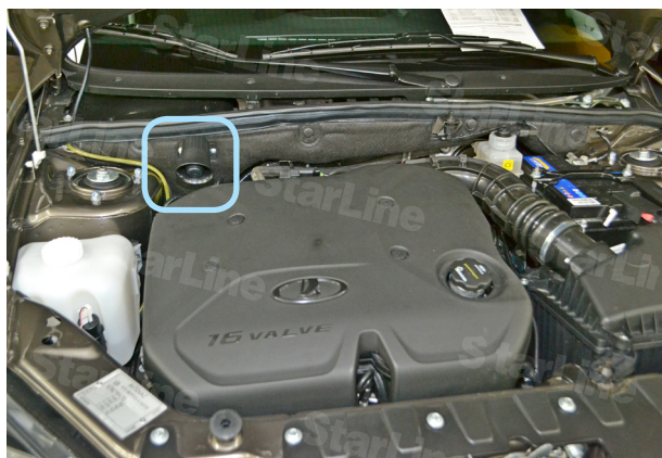
Фото 5.1. Возможное место установки сирены
