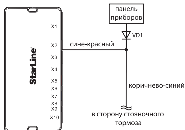
Схема 2. Подключение стояночного тормоза
