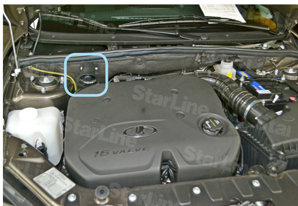
Фото 6.1. Возможное место установки сирены
