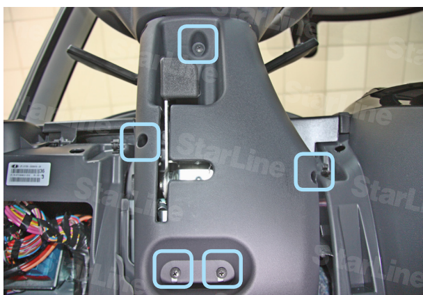
Фото 2.5. Крепление нижней части рулевого кожуха
