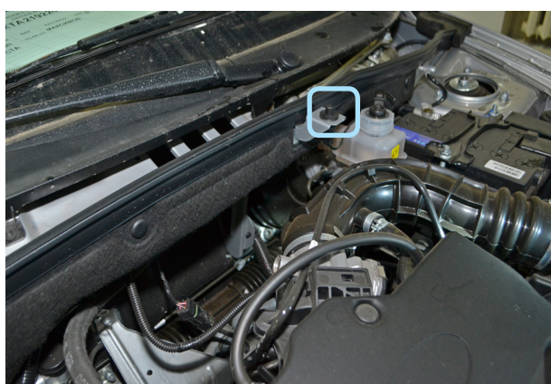
Фото 6.5. Место установки концевика капота
