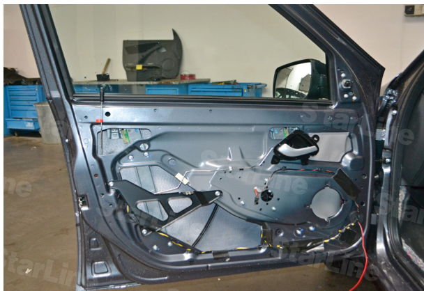
Фото 4.3. Внутренняя обшивка двери водителя снята
