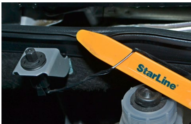
Фото 2.3. Концевик капота (бело-чёрный)
