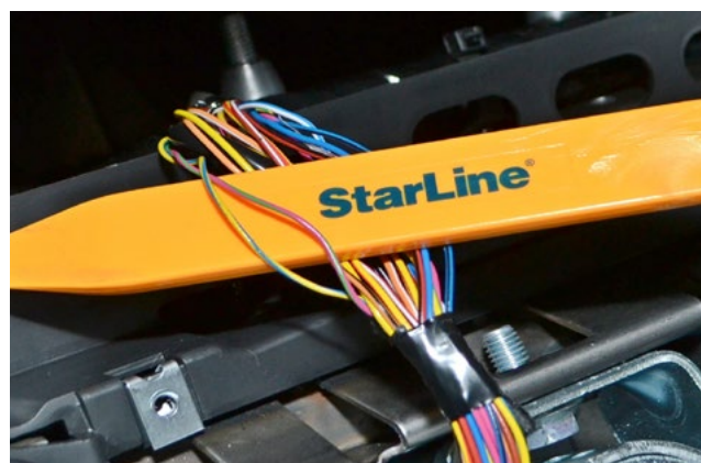
Фото 3.3. Шина CAN-A (розово-зелёный и жёлто-синий)
