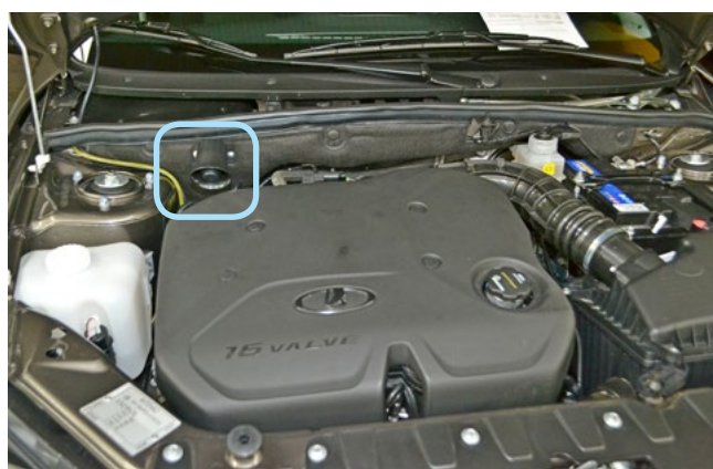
Фото 2.1. Возможное место установки сирены
