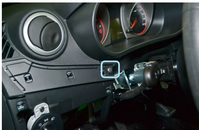
Фото 1.13. Нижний саморез крепления накладки панели приборов
