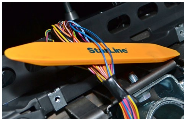
Фото 3.5. Управление световыми сигналами (синий и сине-чёрный)
