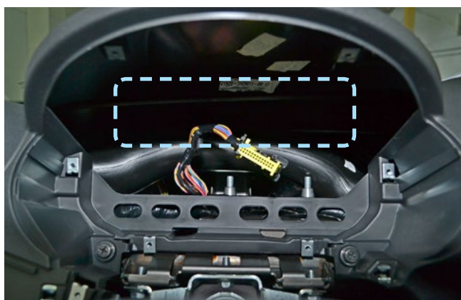
Фото 2.5. Пример расположения центрального блока охранно-телематического комплекса
