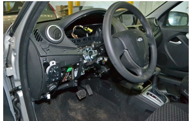
Фото 1.16. Панель приборов снята
