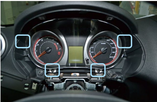
Фото 1.15. Декоративная накладка панели приборов снята. Саморезы крепления панели приборов
