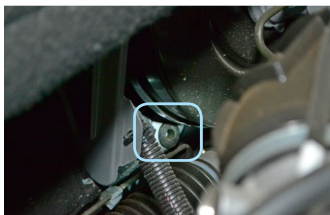
Фото 2.4. Штатный уплотнитель. Вид со стороны капота
