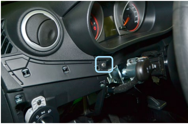
Фото 1.13. Нижний саморез крепления накладки панели приборов
