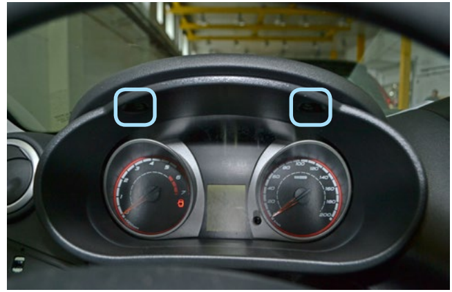
Фото 1.14. Верхние саморезы крепления накладки панели приборов
