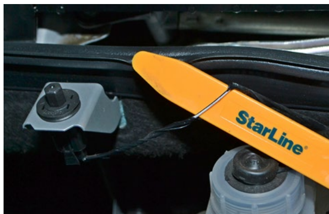
Фото 2.3. Концевик капота (бело-чёрный)
