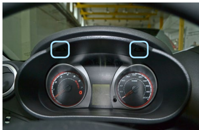
Фото 1.14. Верхние саморезы крепления накладки панели приборов
