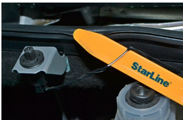
Фото 2.5. Концевик капота (бело-чёрный)
