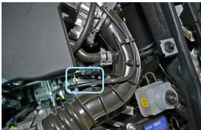
Фото 2.3. Место установки датчика температуры двигателя
