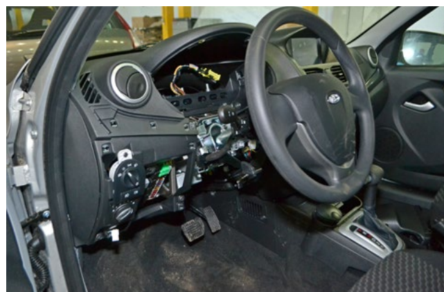
Фото 1.16. Панель приборов снята
