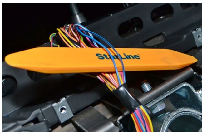
Фото 3.5. Управление световыми сигналами (синий и сине-чёрный)
