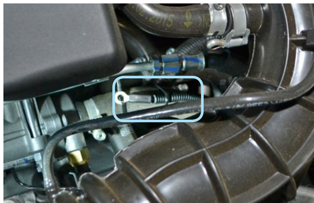
Фото 2.4. Крепление датчика температуры двигателя
