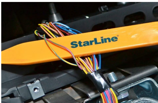
Фото 3.3. Шина CAN-A (розово-зелёный и жёлто-синий)
