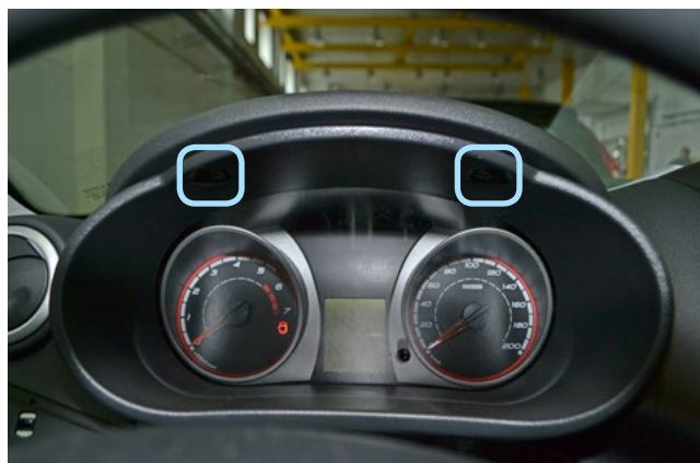
Фото 1.14. Верхние саморезы крепления накладки панели приборов
