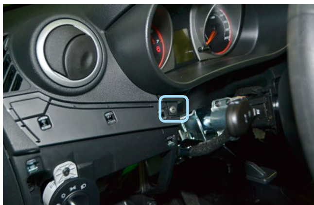
Фото 1.13. Нижний саморез крепления накладки панели приборов
