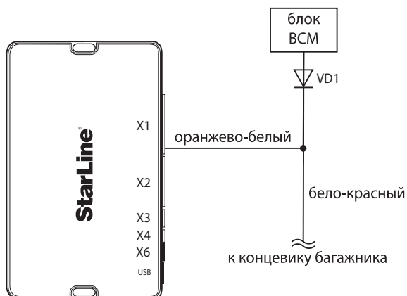
Схема 3. Подключение концевого багажника
