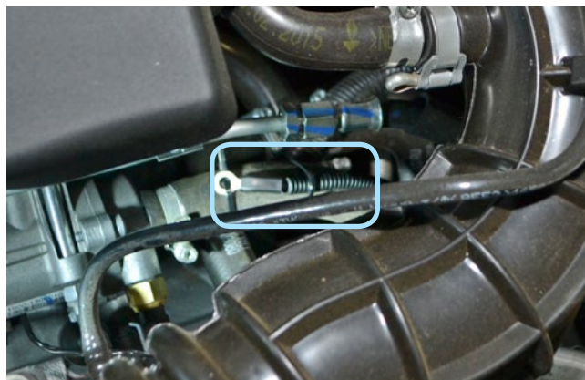
Фото 2.4. Крепление датчика температуры двигателя
