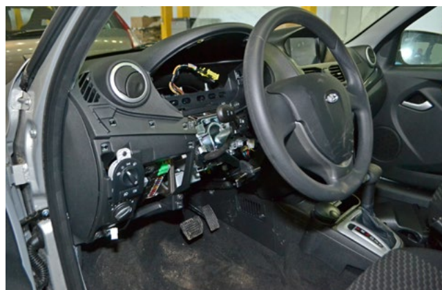
Фото 1.16. Панель приборов снята
