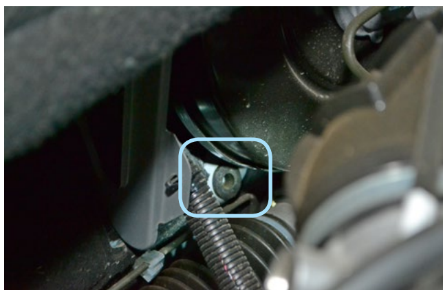
Фото 2.6. Штатный уплотнитель. Вид со стороны капота
