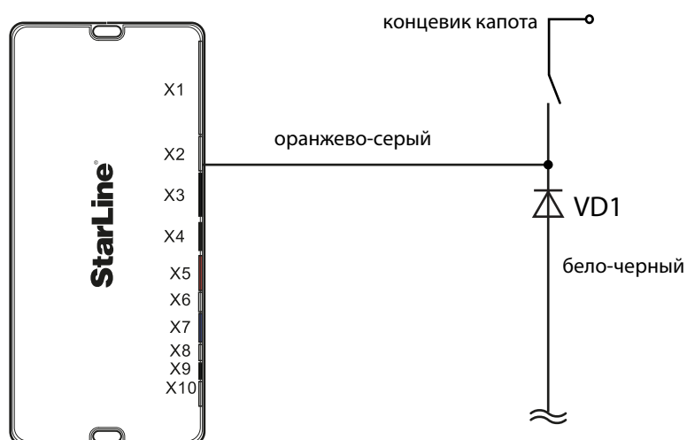
Схема 1. Подключение концевика капота
