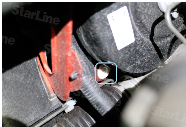
Фото 3.4. Штатное отверстие с резиновым уплотнителем
