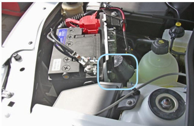
Фото 2.1. Возможное место установки сирены
