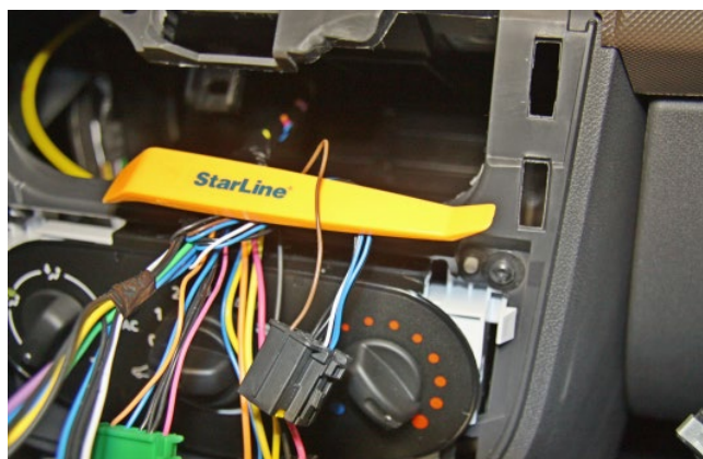
Фото 3.5. Управление световыми сигналами (коричневый)
