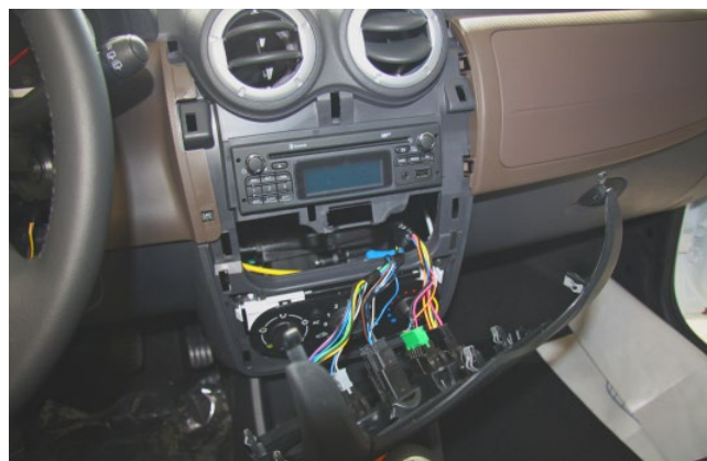
Фото 1.6. Накладка центральной консоли снята
