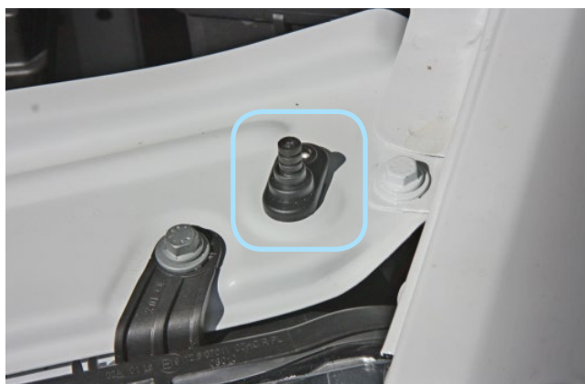
Фото 2.3. Возможное место установки концевика капота
