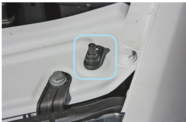
Фото 2.5. Возможное место установки концевика капота
