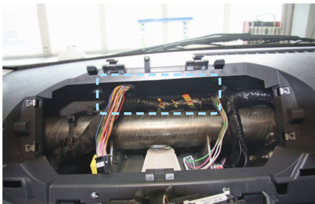
Фото 2.8. Пример расположения центрального блока охранно-телематического комплекса
