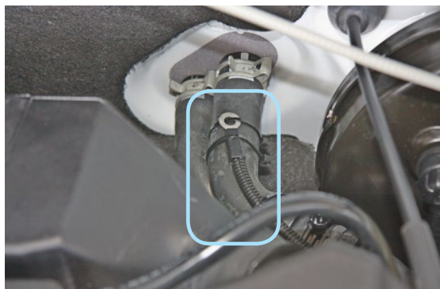
Фото 2.4. Крепление датчика температуры двигателя
