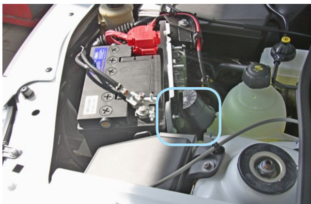
Фото 2.1. Возможное место установки сирены
