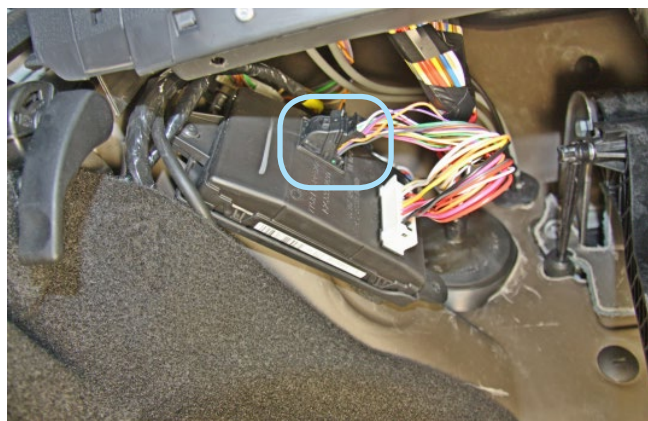
Фото 3.7. Расположение разъёма на блоке BCM
