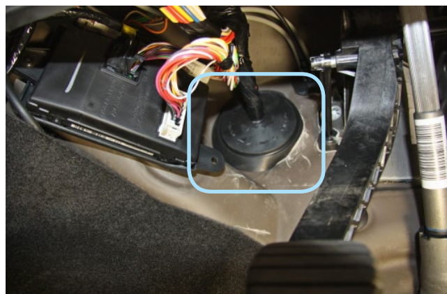
Фото 2.6. Штатный уплотнитель. Вид со стороны салона
