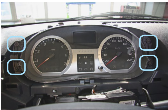
Фото 1.13. Саморезы крепления панели приборов
