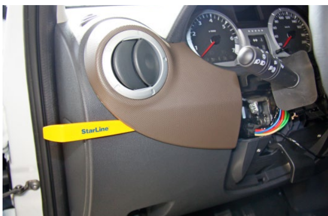
Фото 1.9. Снять левую декоративную накладку панели приборов
