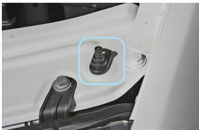
Фото 2.5. Возможное место установки концевика капота
