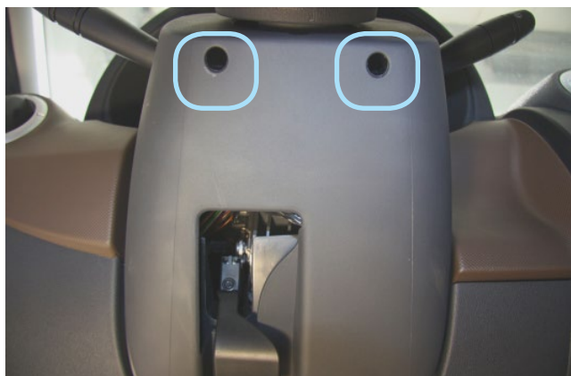
Фото 1.2. Саморезы крепления нижней части
