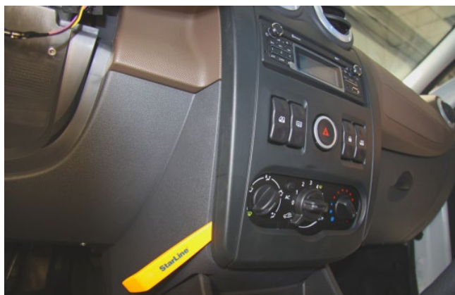
Фото 1.5. Снять декоративную накладку центральной консоли
