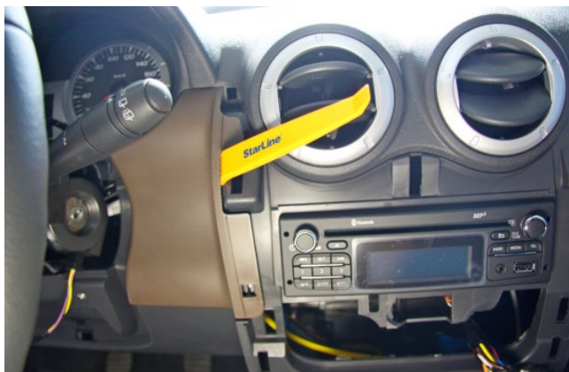
Фото 1.7. Снять правую декоративную накладку панели приборов
