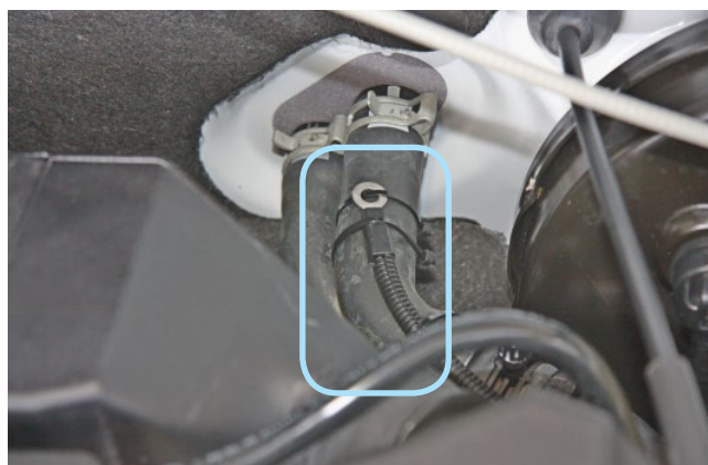
Фото 2.4. Крепление датчика температуры двигателя
