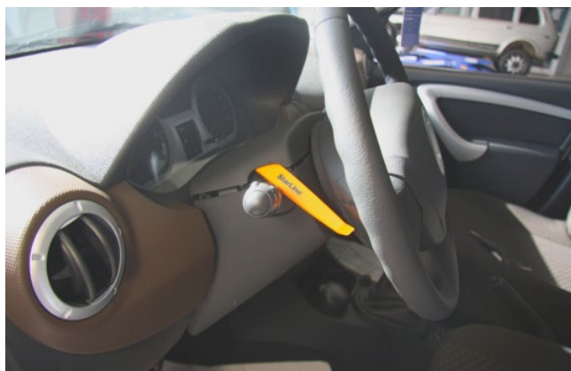
Фото 1.3. Снять верхнюю часть кожуха
