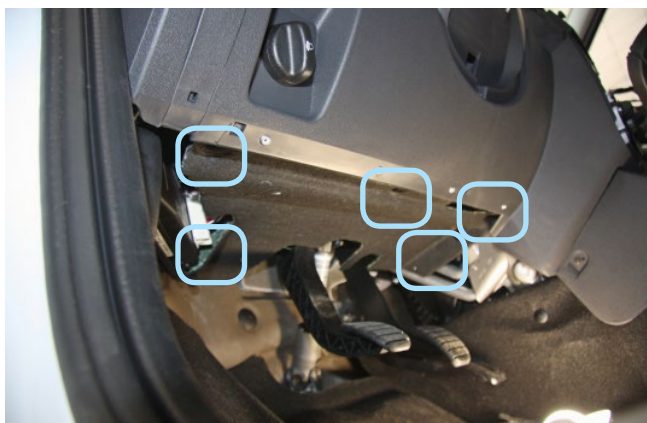
Фото 1.15. Крепление защитной накладки педального узла
