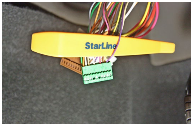
Фото 3.9. Управление индикатором штатного иммобилайзера (фиолетовый)
