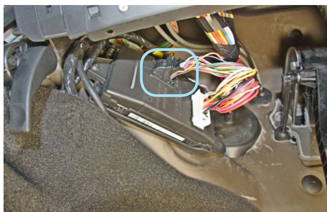
Фото 3.7. Расположение разъёма на блоке BCM
