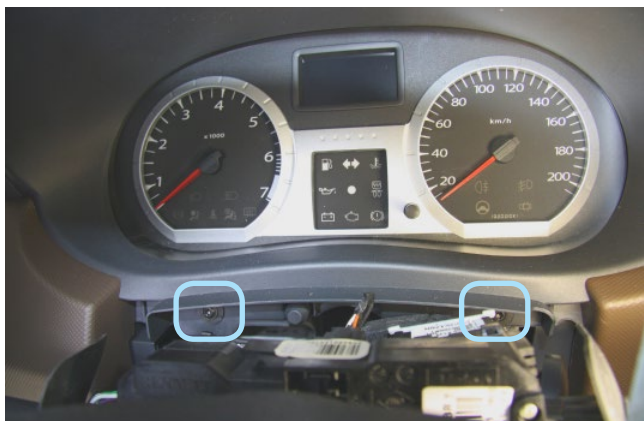
Фото 1.11. Саморезы крепления декоративной накладки панели приборов
