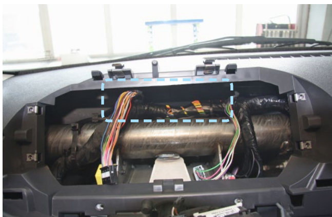
Фото 2.8. Пример расположения центрального блока охранно-телематического комплекса
