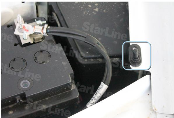
Фото 3.3. Концевик капота
