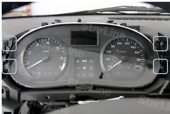
Фото 1.8. Саморезы крепления щитка приборов
