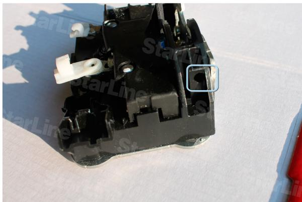
Фото 8.9. Сверлим отверстие 6 мм в замках задних боковых дверей
