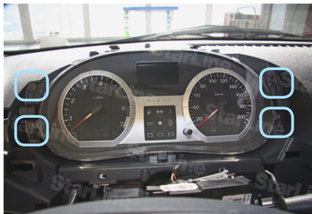
Фото 1.13. Саморезы крепления щитка приборов
