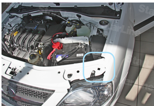
Фото 4.3. Возможное место установки концевика
