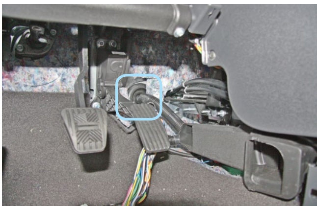
Фото 2.3. Штатный уплотнитель. Вид со стороны салона
