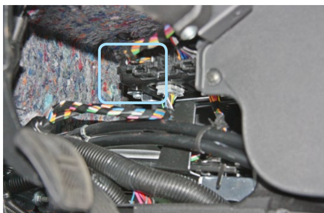
Фото 1.9. Болт и гайка крепления блока ВСМ
