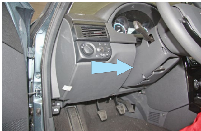
Фото 1.1. Кожух рулевого вала. Общий вид
