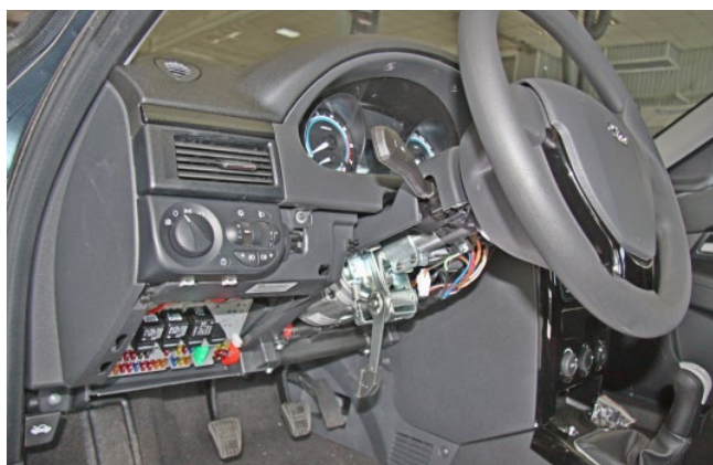
Фото 1.5. Нижняя часть кожуха рулевого вала снята
