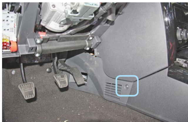
Фото 1.7. Саморез крепления боковой накладки
