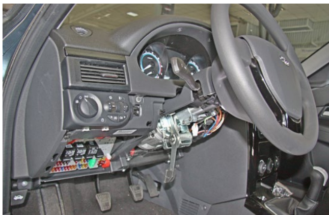
Фото 1.5. Нижняя часть кожуха рулевого вала снята
