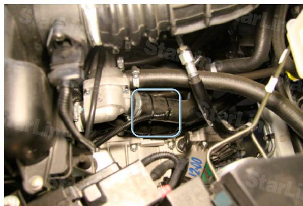
Фото 5.2. Датчик температуры двигателя (крепление на пластиковые хомуты)
