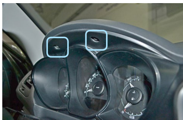
Фото 1.11. Саморезы крепления декоративной накладки панели приборов
