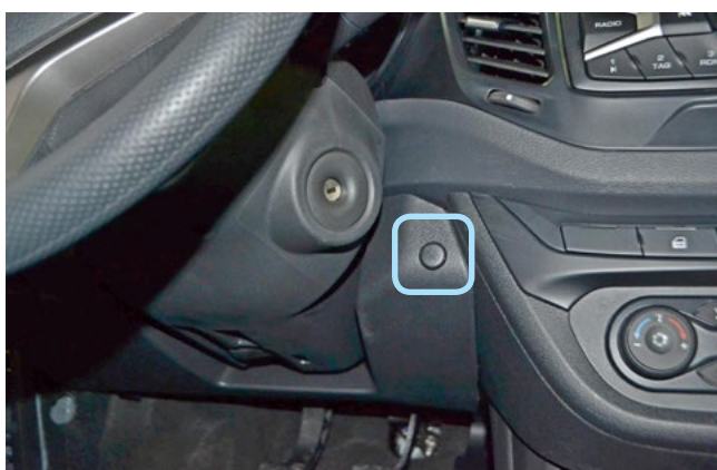
Фото 1.5. Клипса крепления пластиковой накладки под рулевой колонкой
