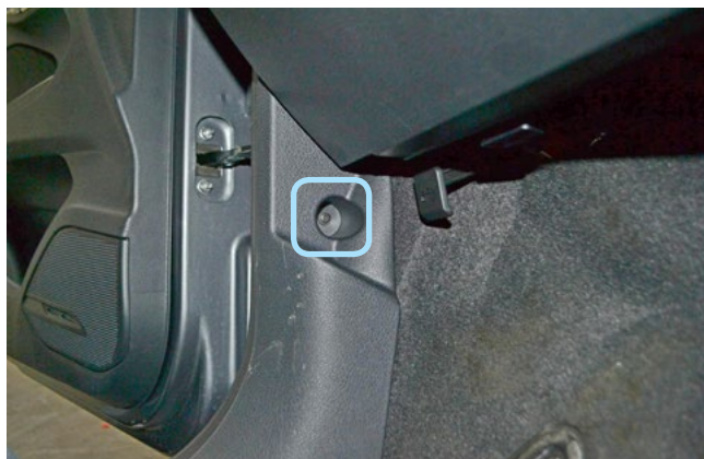
Фото 1.1. Саморез крепления накладки порога двери водителя
