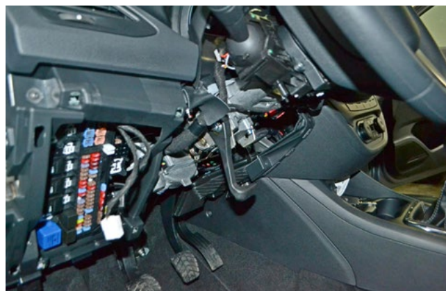
Фото 1.10. Кожух рулевого вала снят
