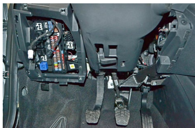
Фото 1.6. Пластиковая накладка под рулевой колонкой снята
