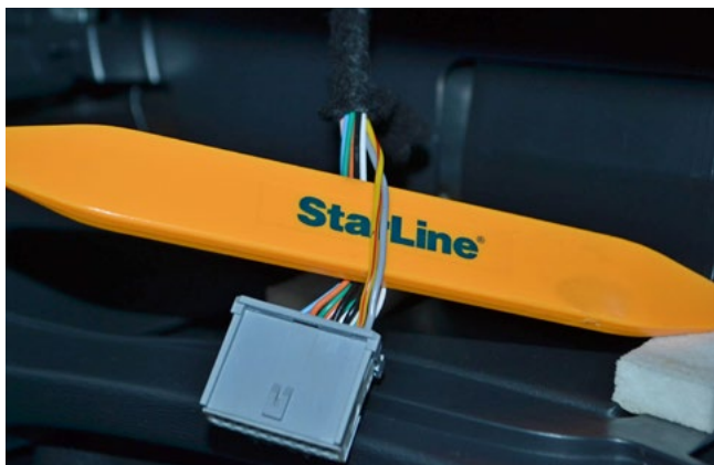
Фото 3.3. Шина CAN-A (жёлто-красный и серый)
