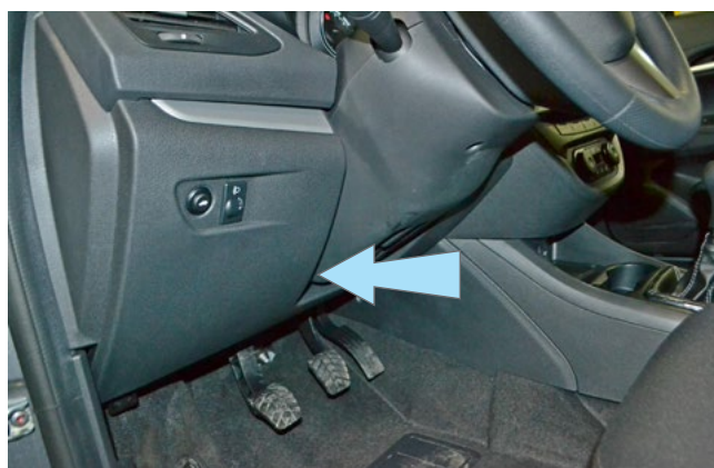
Фото 1.4. Пластиковая накладка под рулевой колонкой. Общий вид
