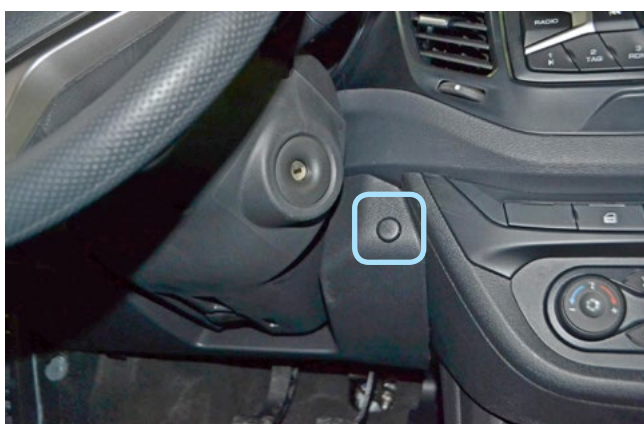
Фото 1.5. Клипса крепления пластиковой накладки под рулевой колонкой
