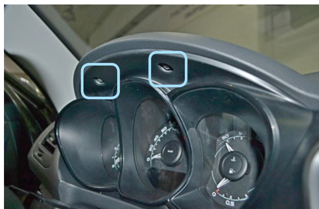
Фото 1.11. Саморезы крепления декоративной накладки панели приборов
