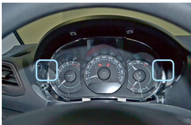
Фото 1.12. Декоративная накладка снята. Саморезы крепления панели приборов
