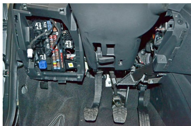
Фото 1.6. Пластиковая накладка под рулевой колонкой снята
