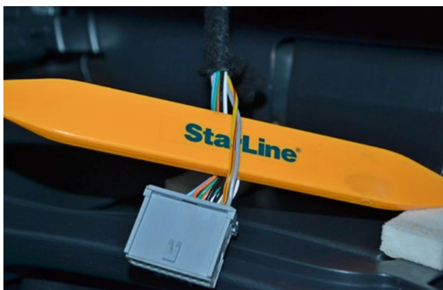
Фото 3.3. Шина CAN-A (жёлто-красный и серый)
