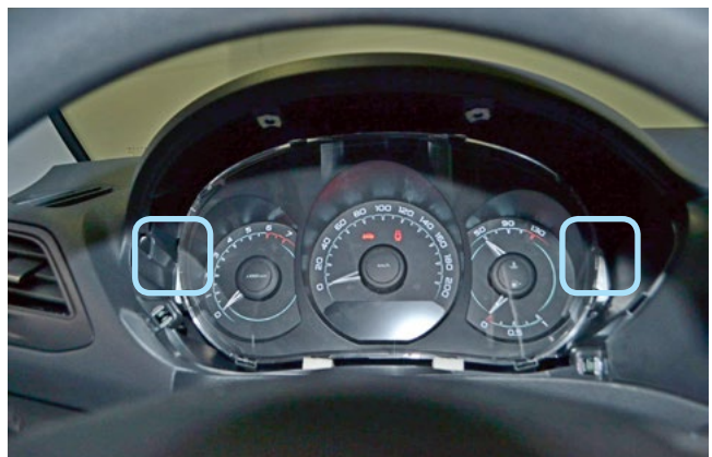
Фото 1.12. Декоративная накладка снята. Саморезы крепления панели приборов
