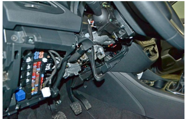
Фото 1.10. Кожух рулевого вала снят
