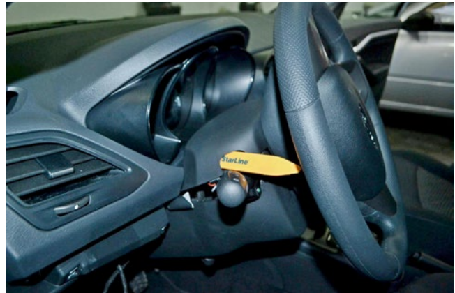
Фото 1.8. Снять верхнюю часть рулевого кожуха
