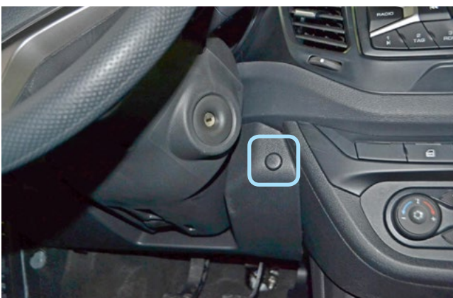
Фото 1.5. Клипса крепления пластиковой накладки под рулевой колонкой
