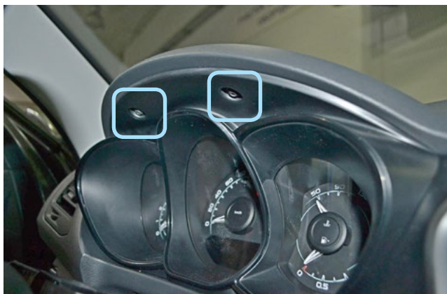
Фото 1.11. Саморезы крепления декоративной накладки панели приборов
