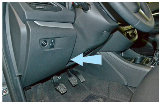
Фото 1.4. Пластиковая накладка под рулевой колонкой. Общий вид
