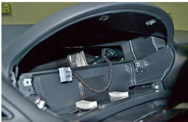
Фото 1.13. Панель приборов снята
