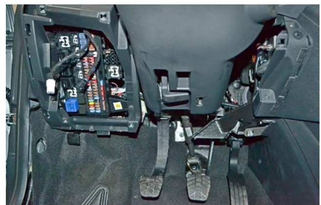
Фото 1.6. Пластиковая накладка под рулевой колонкой снята
