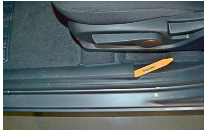
Фото 1.2. Снять пластиковую накладку порога двери водителя
