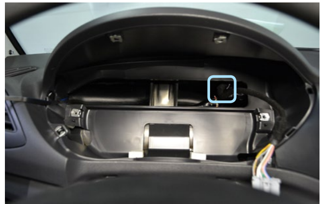
Фото 2.7. Возможное место установки антенны GPS+GLONASS
