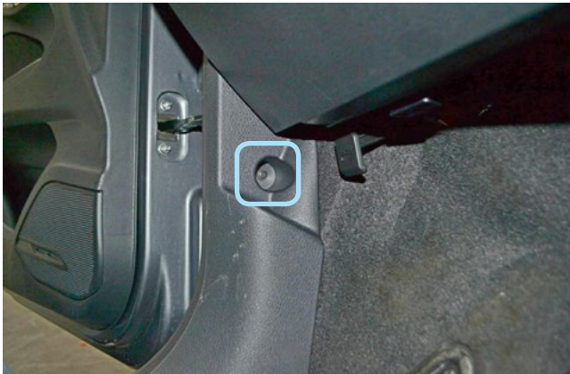
Фото 1.1. Саморез крепления накладки порога двери водителя
