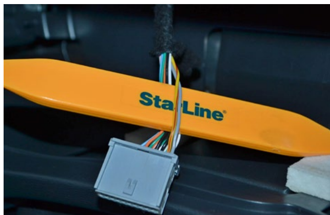
Фото 3.3. Шина CAN-A (жёлто-красный и серый)
