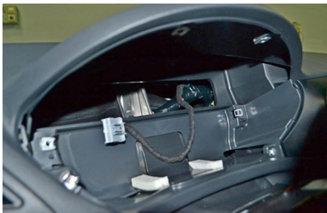
Фото 1.13. Панель приборов снята
