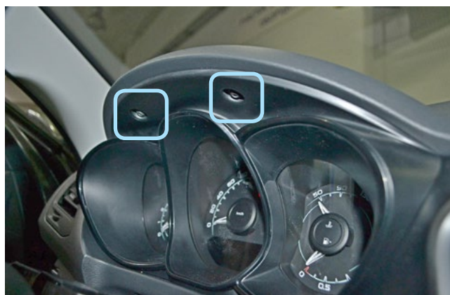
Фото 1.11. Саморезы крепления декоративной накладки панели приборов
