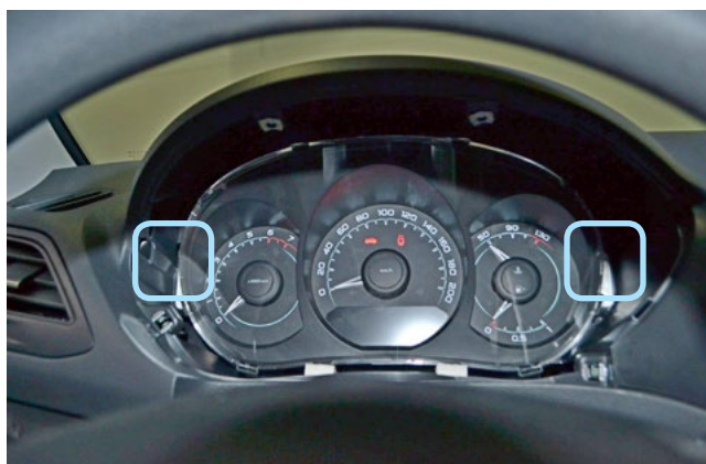
Фото 1.12. Декоративная накладка снята. Саморезы крепления панели приборов
