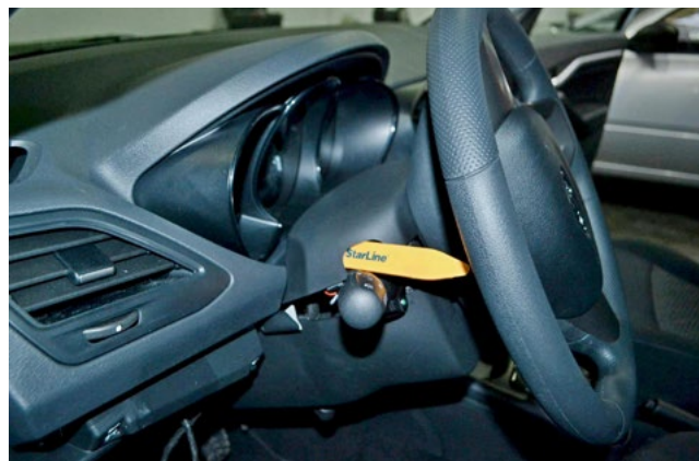
Фото 1.8. Снять верхнюю часть рулевого кожуха
