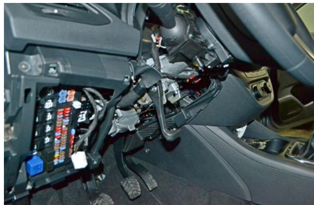
Фото 1.10. Кожух рулевого вала снят
