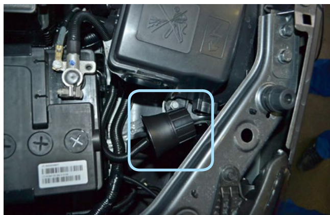
Фото 2.1. Возможное место установки сирены
