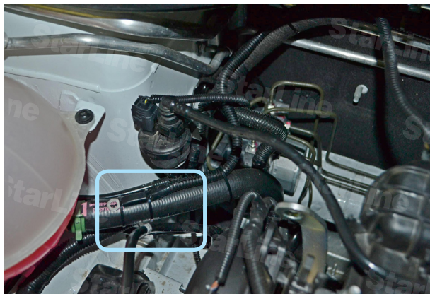
Фото 6.3. Место установки датчика температуры двигателя
