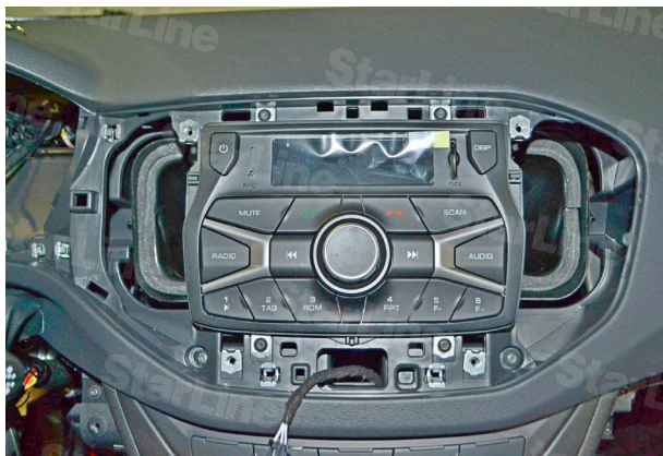
Фото 4.3. Центральные воздуховоды сняты
