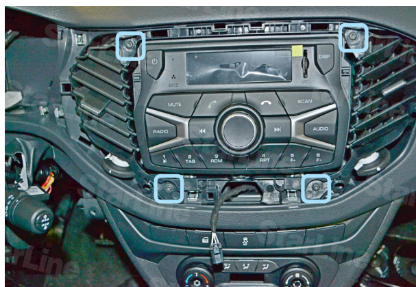
Фото 4.2. Саморезы крепления воздуховодов
