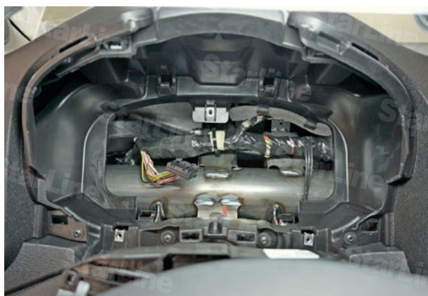
Фото 2.5. Панель приборов снята
