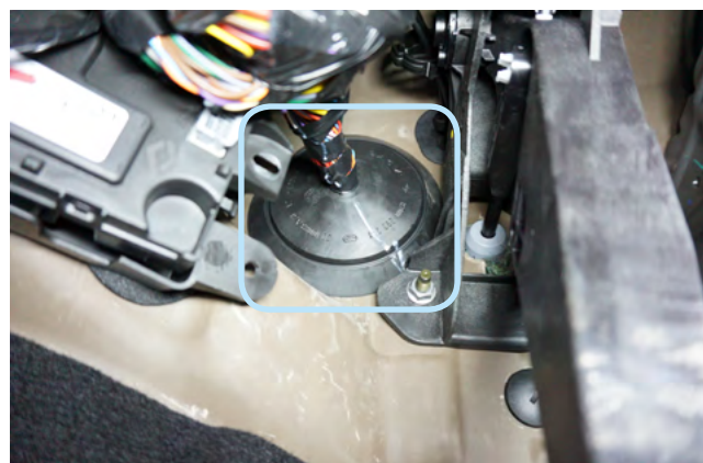
Фото 2.6. Штатный уплотнитель. Вид со стороны салона
