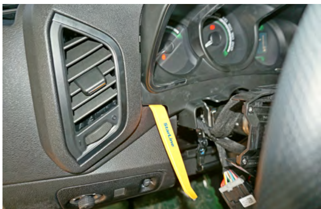
Фото 1.6. Снять накладку панели приборов
