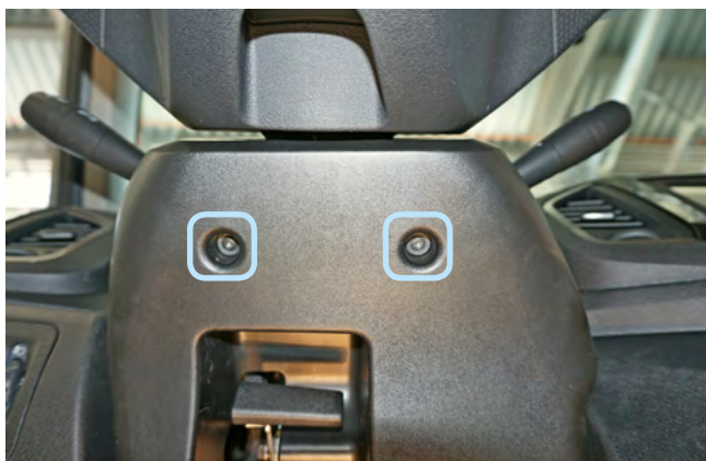
Фото 1.1. Саморезы крепления кожуха рулевого вала
