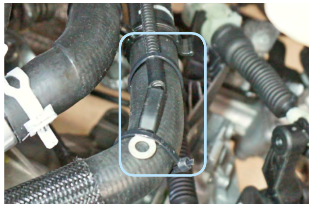
Фото 2.4. Крепление датчика температуры двигателя
