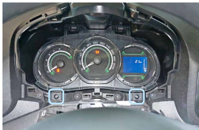
Фото 1.7. Накладка панели приборов снята. Саморезы
