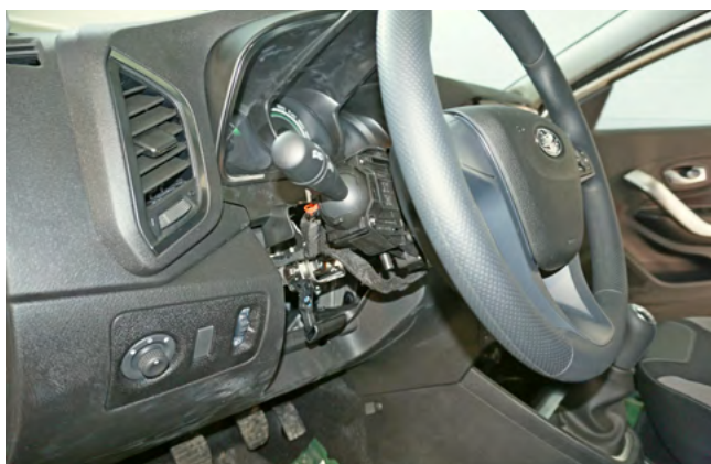
Фото 1.3. Кожух рулевого вала снят
