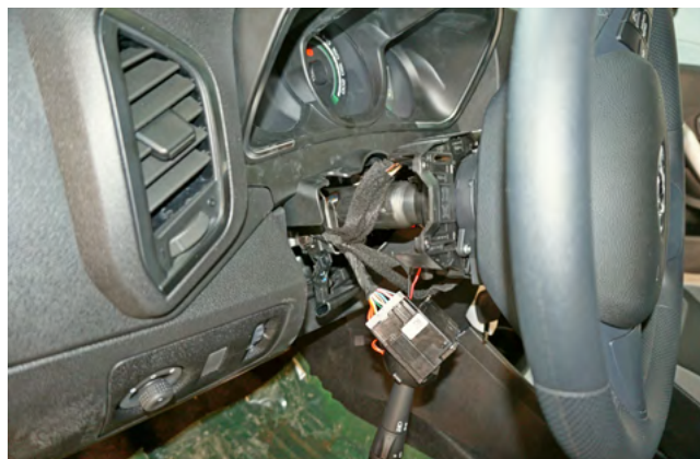
Фото 1.5. Ручка управления сигналами поворотов снята
