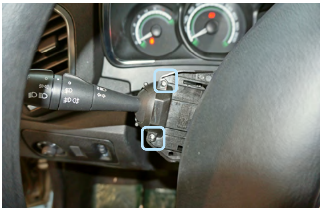
Фото 1.4. Саморезы крепления ручки управления сигналами поворотов
