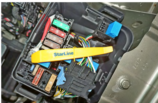
Фото 2.9. Подключение цепи зажигания (жёлтый)
