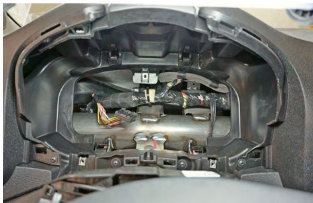
Фото 1.8. Панель приборов снята
