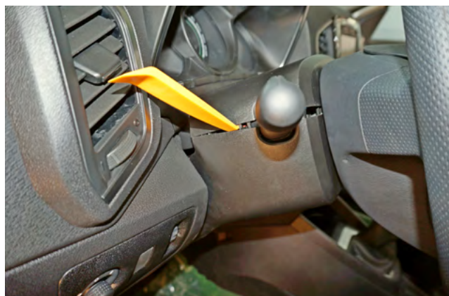
Фото 1.2. Снять кожух рулевого вала
