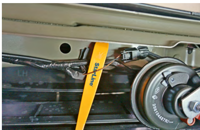
Фото 2.11. Контроль концевика капота (коричневый)
