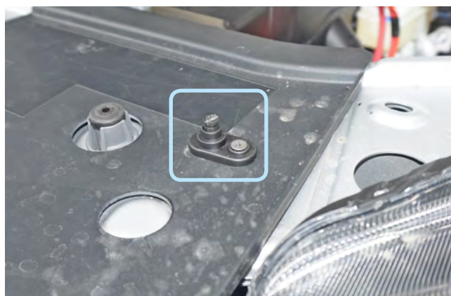
Фото 2.5. Возможное место установки концевика капота
