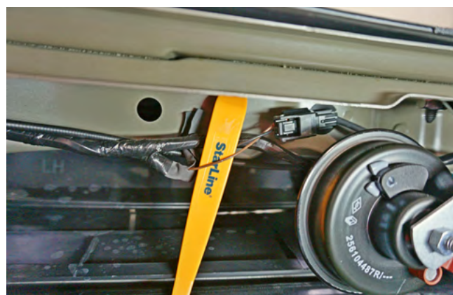
Фото 2.11. Контроль концевика капота (коричневый)
