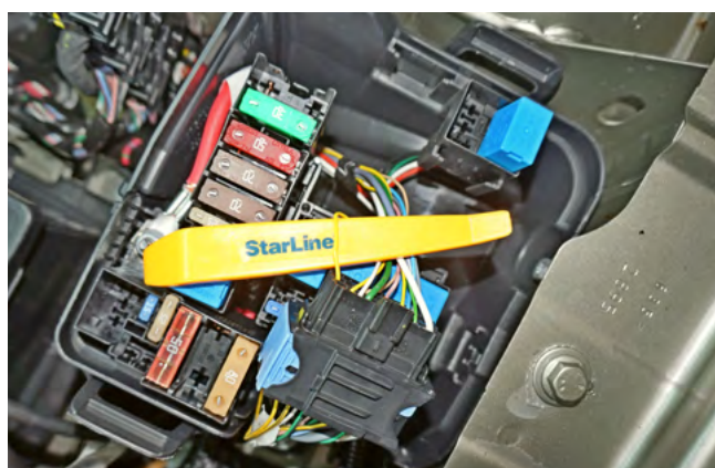
Фото 2.9. Подключение цепи зажигания (жёлтый)
