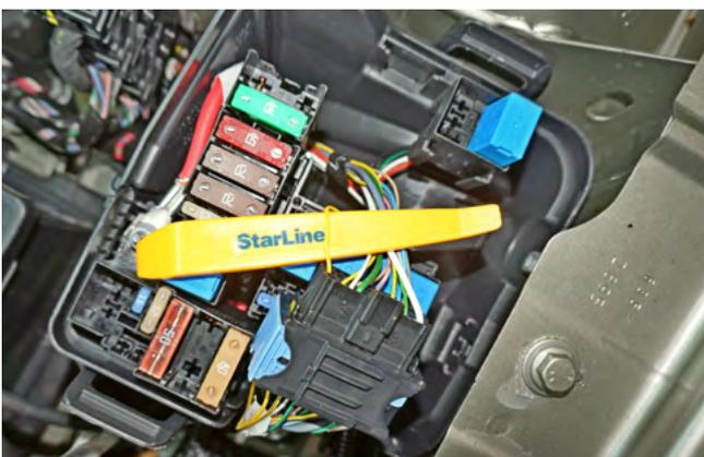
Фото 2.9. Подключение цепи зажигания (жёлтый)
