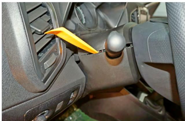
Фото 1.2. Снять кожух рулевого вала
