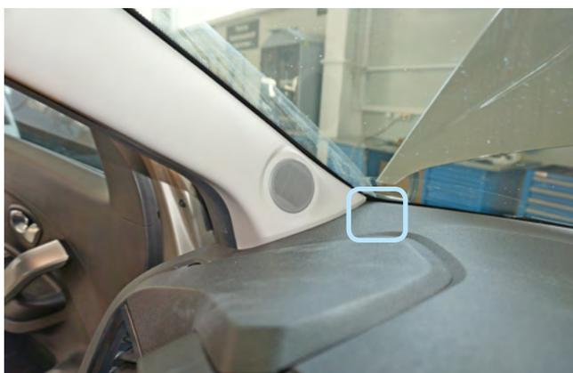
Фото 2.12. Возможное место установки антенны GPS+GLONASS
