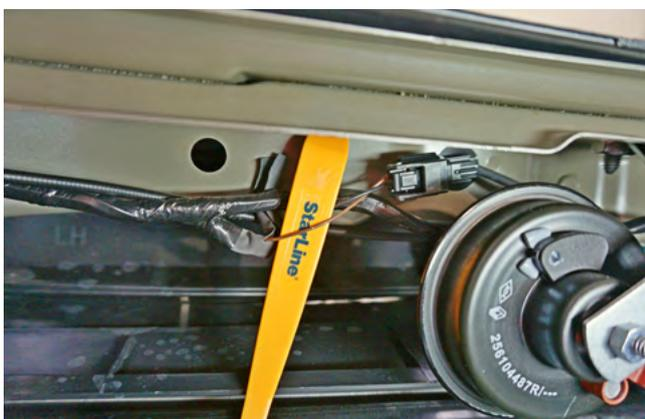
Фото 2.11. Контроль концевика капота (коричневый)
