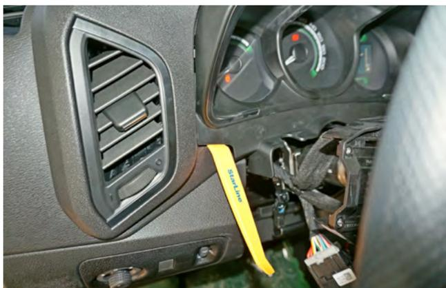
Фото 1.6. Снять накладку панели приборов
