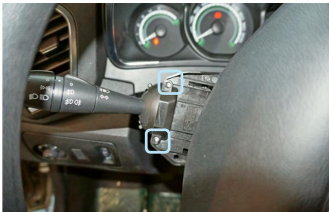
Фото 1.4. Саморезы крепления ручки управления сигналами поворотов
