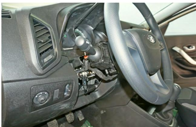
Фото 1.3. Кожух рулевого вала снят
