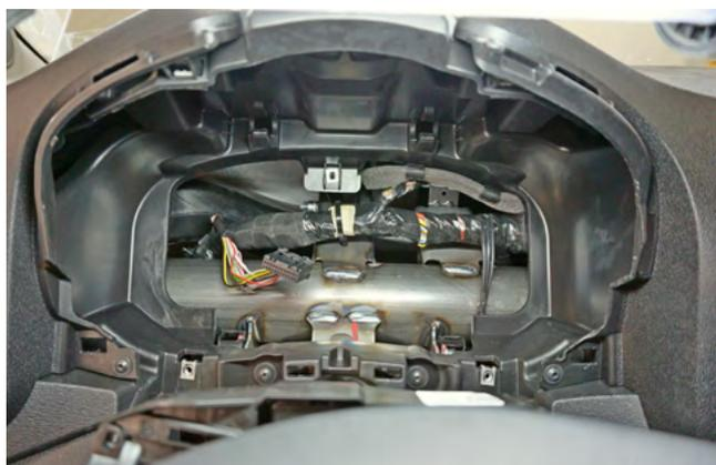
Фото 1.8. Панель приборов снята
