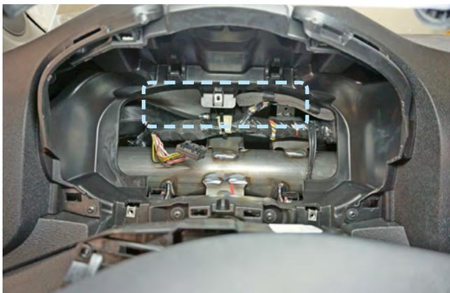
Фото 2.13. Пример расположения центрального блока охранно-телематического комплекса
