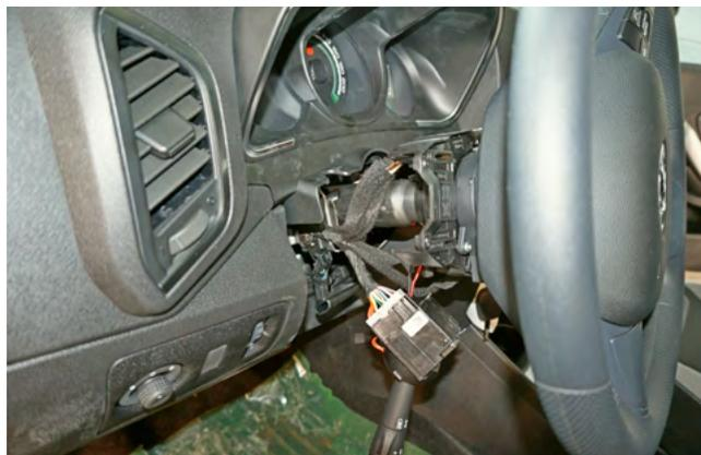
Фото 1.5. Ручка управления сигналами поворотов снята
