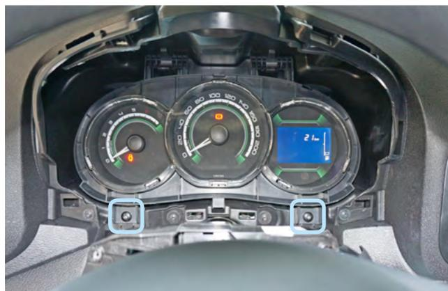
Фото 1.7. Накладка панели приборов снята. Саморезы
