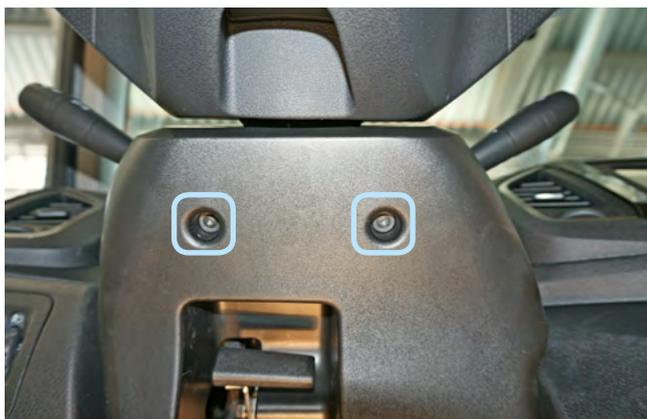
Фото 1.1. Саморезы крепления кожуха рулевого вала
